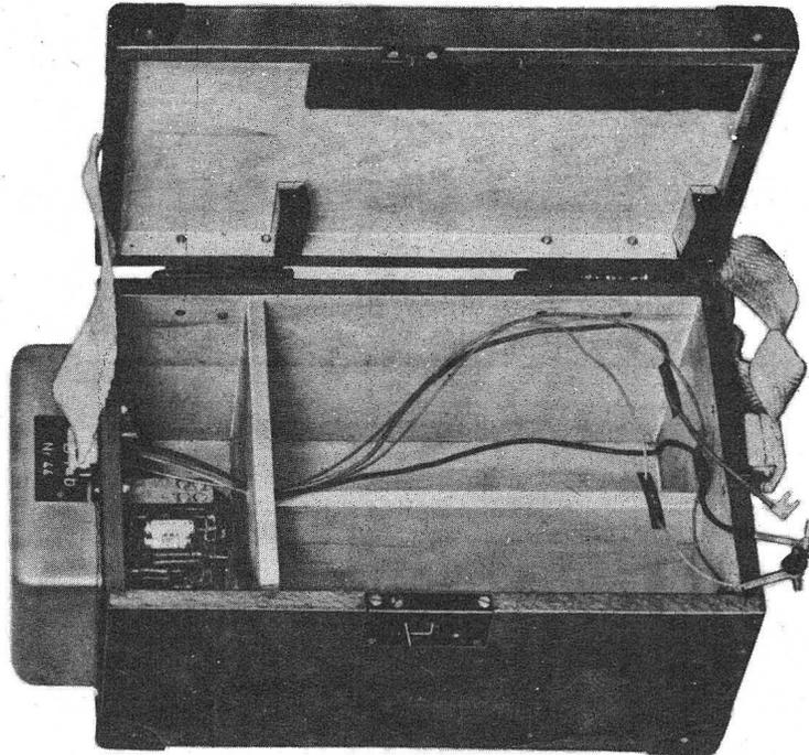
Der B 14b dient zur Speisung bestimmter Kondensatormikrofone. Er enthält in einem Holzkasten mit Tragegurt außer den Batterien Schaltelemente, die mit dem Mikrofon einen einstufigen Katoden-Verstärker bilden. Zum Anschluß des Mikrofons ist eine S 62 und für die abgehende Modulationsleitung ein S 58 auf der Montageplatte an der einen Stirnseite vorgesehen.
