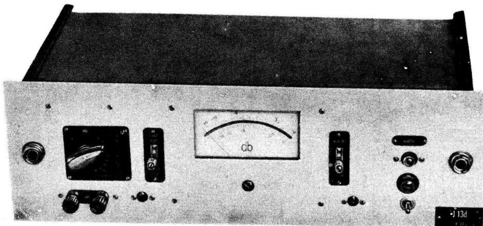
Dient zur Pegelmessung an niederfrequenten Übertragungssystemen. Enthält ein abschaltbares Ohrkurvenfilter für Geräuschspannungsmessungen. Kopfhörerausgang ist vorhanden. Vom symmetrischen Eingang geht es über den Meßbereichschalter, das überbrückbare Ohrkurvenfilter und einen vierstufigen Widerstandsverstärker zum Meßteil mit Gleichrichter und Anzeigeinstrument.
