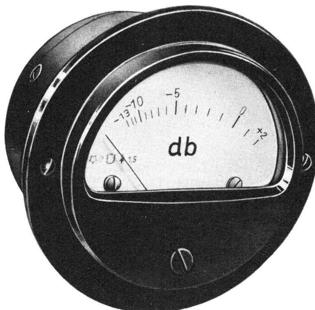
Der J 16 c wird als Pegelzeiger in Geräten verwendet. Er besteht aus einem Drehspulinstrument mit eingebautem Meßgleichrichter. Der auf der Skala angegebene Wert ist 10 dB niedriger als der an den Anschlüssen des Instrumentes liegende Pegel.
