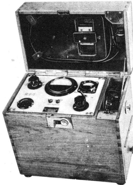
Der J 29 a ist ein tragbares Gerät zur Messung der Stärke und Richtung magnetischer Störfelder von Netztrafos, E-Motoren, anderen Geräten und Leitungen. Die vom Störfeld in einer Tastspule induzierte Spannung wird durch einen dreistufigen RC-gekoppelten Meßverstärker verstärkt und durch ein Instrument zur Anzeige gebracht.
