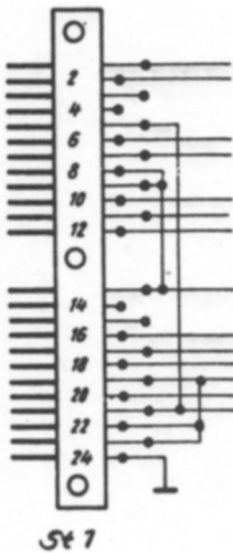
Beschaltung der Messerleiste
